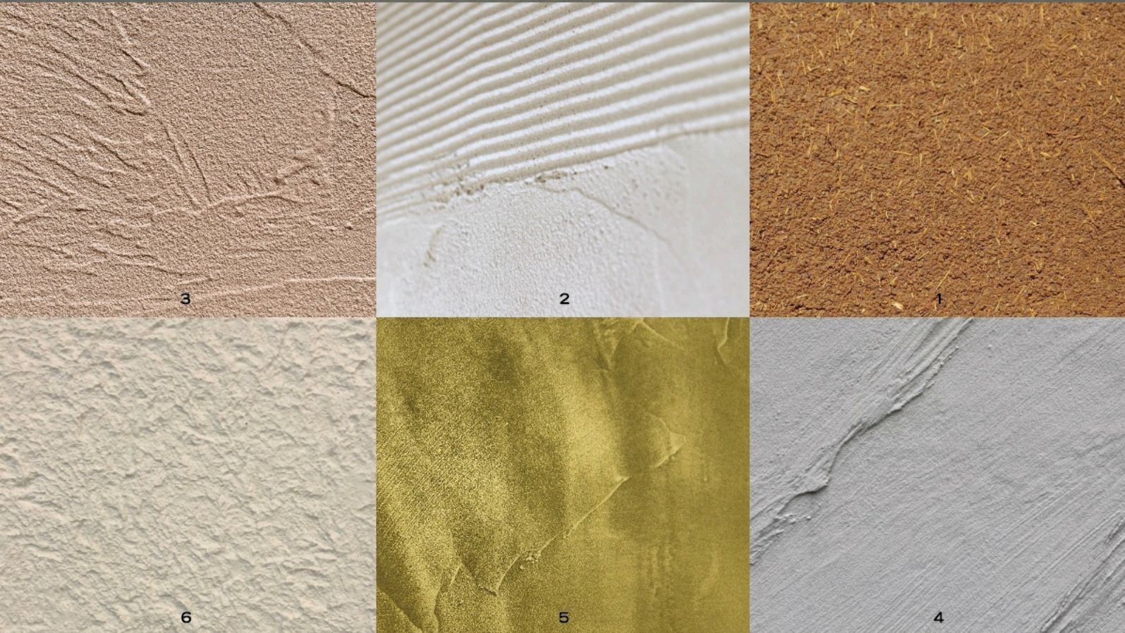
1 ワラや砂を混ぜた昔ながらの土壁 2 クシ引きとラフなコテむらを塗り分けた漆喰壁 3 自然素材プームの火付け役となった調湿効果の高い珪藻土壁 4 ラフに塗ったモルタルのテクスチャー 5 樹脂に真鍮を混ぜた金属調磨き仕上げ 6 重厚な凹凸が特徴のスタッコ仕上げ
